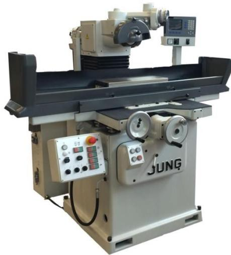
JF 520, gereinigt, Geometrie überholt, Verschleißteile neu, Elektrik überprüft und defekte Teile erneuert, Messsysteme überholt, Spindelmotor überholt, Lack neu
